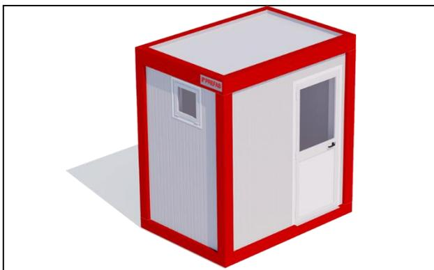
**STRUTTURA PORTANTE:** Telaio in acciaio zincato costituito da profili presso piegati saldati e imbullonati, con spessore a partire da 20/10. Gli elementi a vista della struttura sono verniciati con smalto acrilico color grigio RAL 9002.
